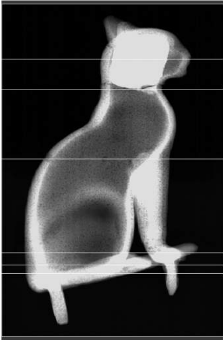
Abb. 9 Radiographie der Katze. Die Porosität, sowie die Bleiauffüllung im Kopf ist erkennbar. Ausser den Beinen ist die Bronze als Hohlguß erkennbar
